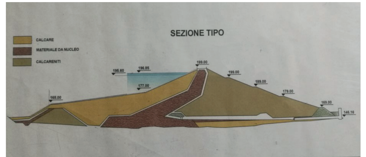
Fig. 5 e 6 - Sopra: lato nord-ovest dell'invaso Poma; sbarramento, paramento di monte con coronamento e scarichi di superficie. Sotto: Sezione trasversale e schema dei materiali che formano il corpo della diga
